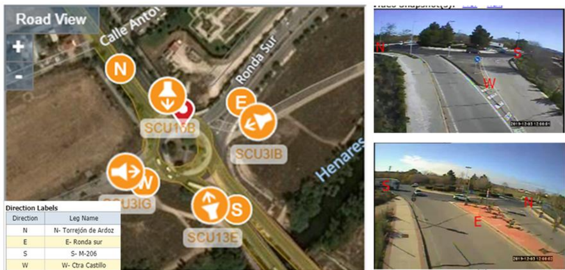
Figura 18. Disposición de las cámaras en los trabajos de campo
