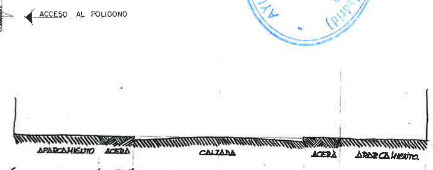
SECCION VIARIO TIPO 1. 2d US ENTRE FACHADAS
