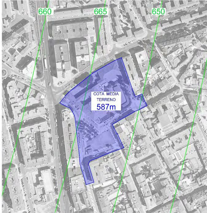
Detalle de la limitación de altura de las servidumbres radioeléctricas del aeropuerto militar de Torrejón de Ardoz.
