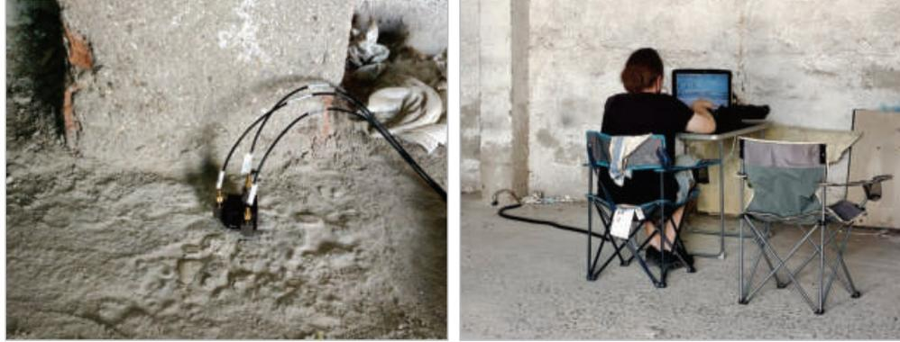
*Figura 6. Imágenes del punto de medición y fijación de los acelerómetros.*
